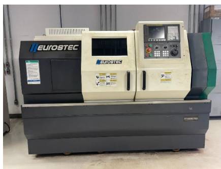
Figura 1. Torno CNC Eurostec usado no processo de usinagem.
