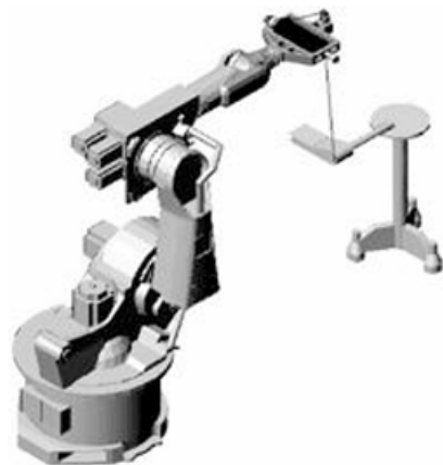
Figura 4: Esquema do braço robótico usado no Enrolamento Robotizado (Carrino et al., 2004)
