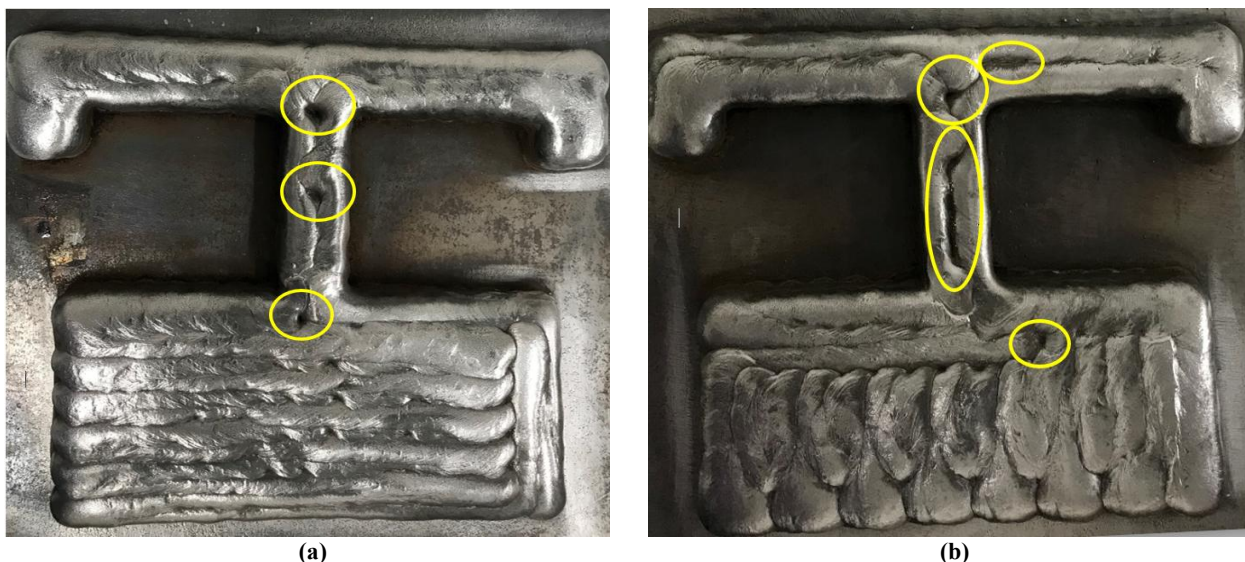
Figura 5. Peças impressas usando o planejamento de trajetória Pixel: (a) Pixel convencional; (b) Pixel intercalado.
