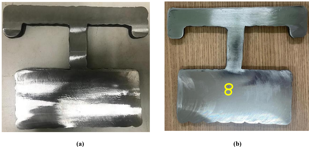
Figura 6. Peças impressas usando o planejamento de trajetória Pixel usinado: (a) Pixel convencional; (b) Pixel intercalado.
