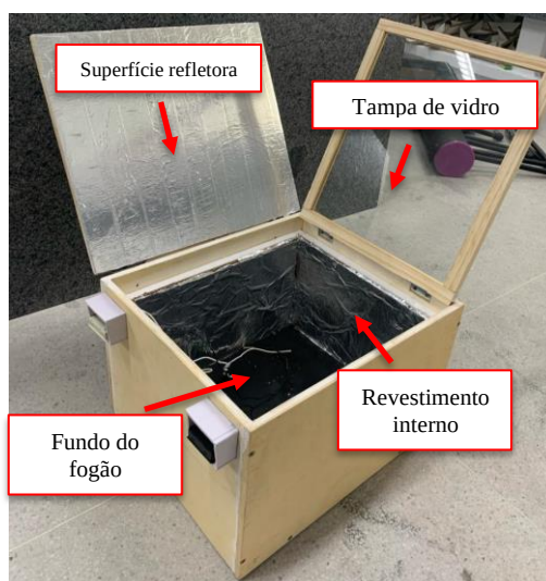
Figura 2. Fogão construído e revestido.
