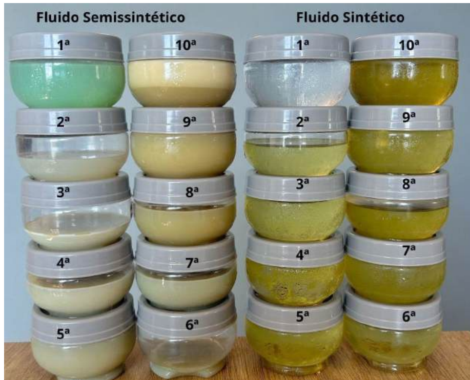
Figura 4: Progressão visual das amostras de fluidos de corte semissintético e sintético.
