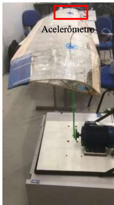
Figura 5. Montagem dos acelerômetros na asa
