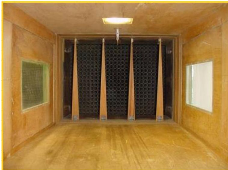
Figura 3. Dispositivos de simulação do vento atmosférico.
