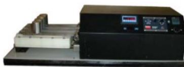
Figura 1. Equipamento típico para ensaio de abrasão para identificação do número de Miller. Ureel et al, 2014.
