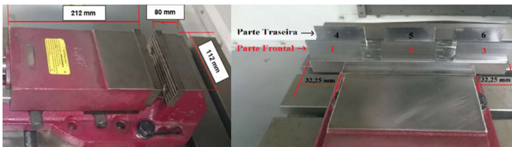
Figura 7. Dimensões da morsa e da fixação da peça.
