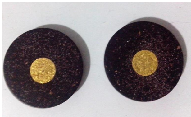
Figura (1): Fotografia das amostras de Cu Al Be Cr após tratamento metalografico.
