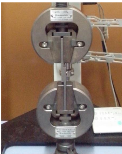
Figura 2: Ensaio de Cisalhamento da liga com memória de forma.
