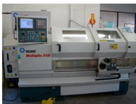
Figura 5. Torno CNC Romi Multiplic 35D utilizado nos testes de torneamento (Pereira, 2009).
