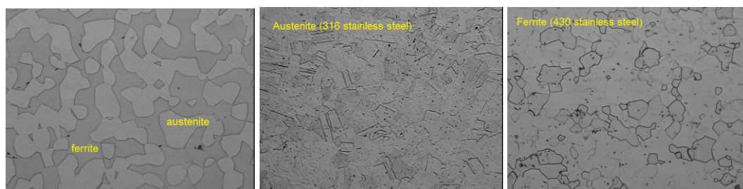
Figura 3. Micrografia ótica dos aços inoxidáveis com aumento de 500x.
