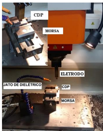
Figura 3. Fixação do corpo de prova na máquina de eletroerosão
