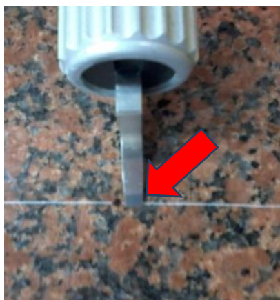
Figura 5. Medição da vazão volumétrica de forma indireta pelo diâmetro do filamento.
