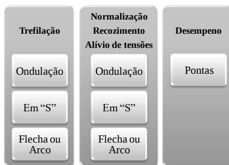
Figura 7. Processos e tipo de empenamentos encontrados.
