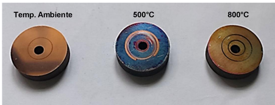
Figura 2 - Imagem das trilhas de desgaste produzidas nas amostras após ensaios tribológicos nas temperaturas de 20 °C, 500 °C e 800 °C.
