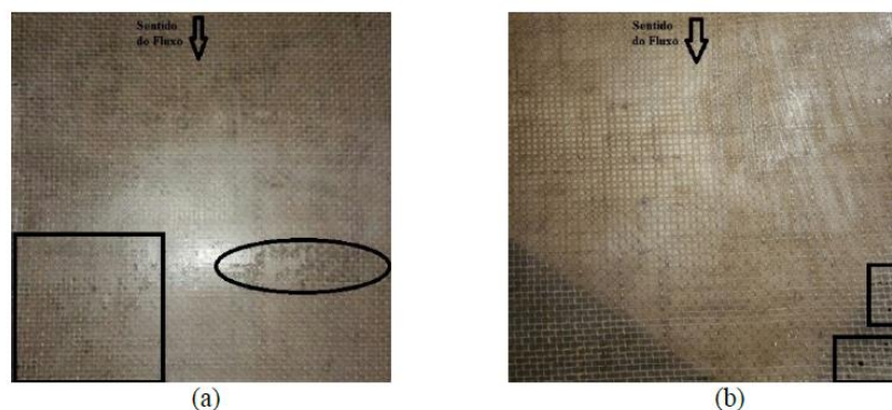
Figura 4. Homogeneidade da matriz poliéster (a) Compósito sem retardante e (b) Compósito com retardante.
