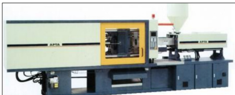
Figura 4. Máquina Injetora Himaco modelo APTA 180 ECO. Fonte: (Himaco, 2015).
