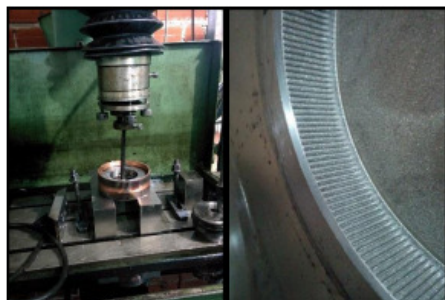
Figura 13. À esquerda eletroerosão, à direita resultado do acabamento final.
