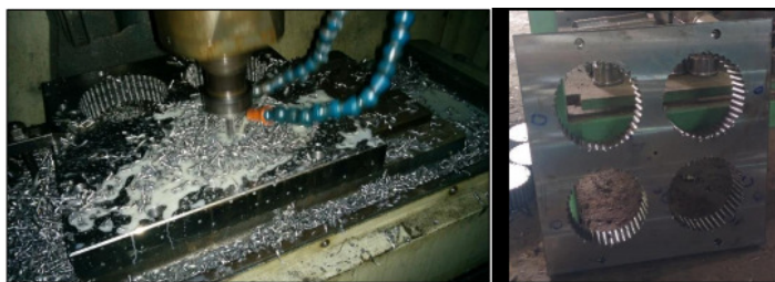
Figura 10. À esquerda furação de perímetro da cavidade, à direita peça pós processo.
