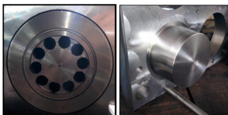
Figura 12. À esquerda canais de refrigeração do postigo macho, à direita parte frontal do postigo.
