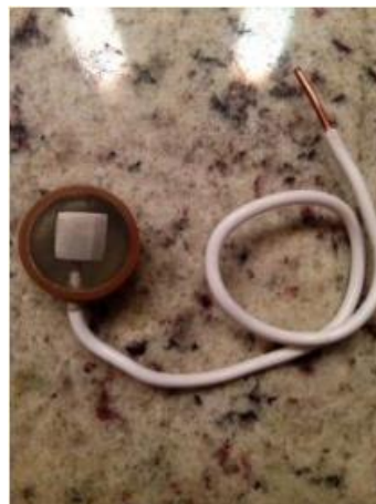
Figura 4. Amostra embutida e lixada
