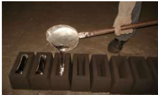
Figura 3. Vazamento do alumínio fundido nos moldes de areia
