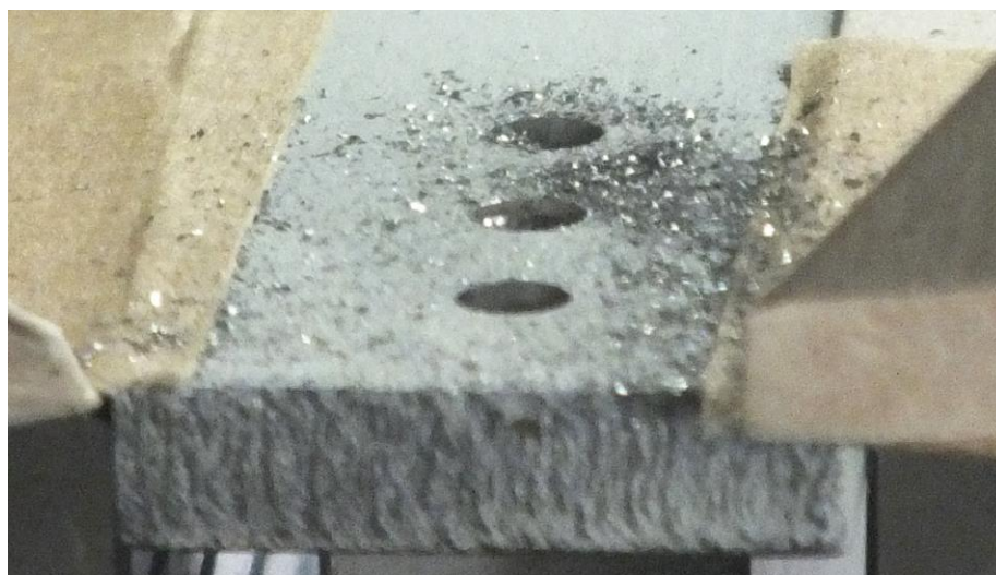
Figura 7. Coleta dos cavacos para análise e validação do modelo.
