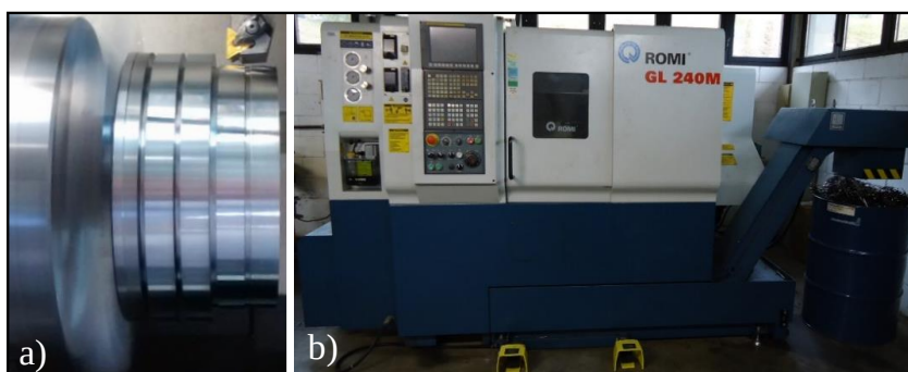
Figura 1. a) Corpo de Prova; b) Centro de Torneamento ROMI GL 240M. (Fonte: Autoria Própria)
