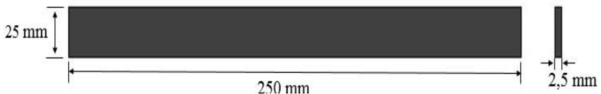
Figura 7. Dimensões do corpo de prova conforme norma ASTM D-3039.
