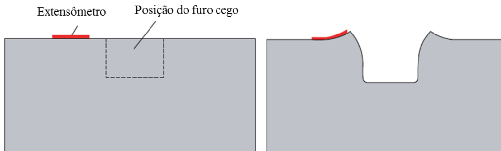
Figura 1. Medição de tensão com perfil uniforme abaixo da superfície da amostra (Schajer, 2013).
