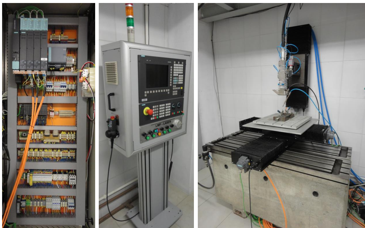
Figura 3. Três principais módulos que compõe o sistema – PCP - PCE – Sistema de Movimentação (Adaptado de Gutjahr (2016)).
