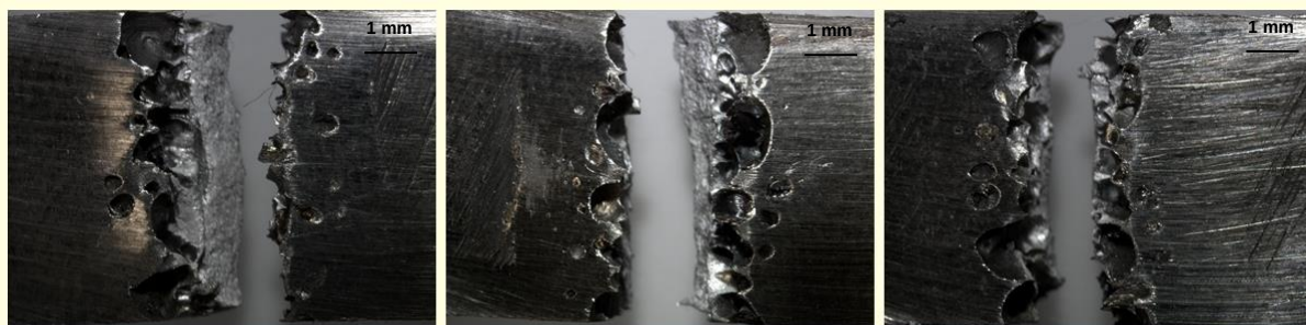
Figura 6. Imagens detalhadas do rompimento do ensaio de tração CP 1.
