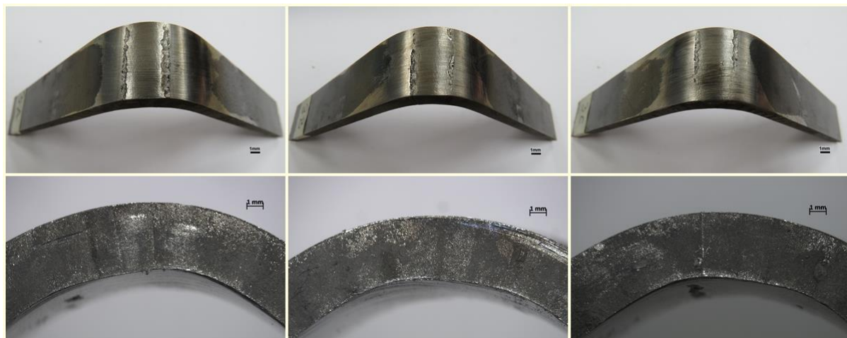
Figura 15. Ensaio de dobramento aplicado no CP 3.
