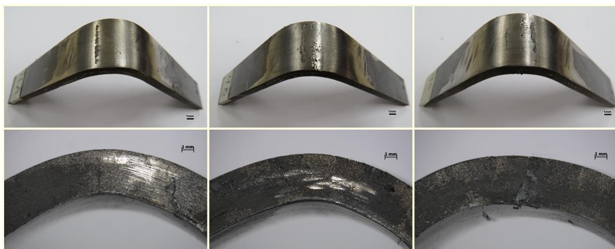
Figura 16. Ensaio de dobramento aplicado no CP 4.
