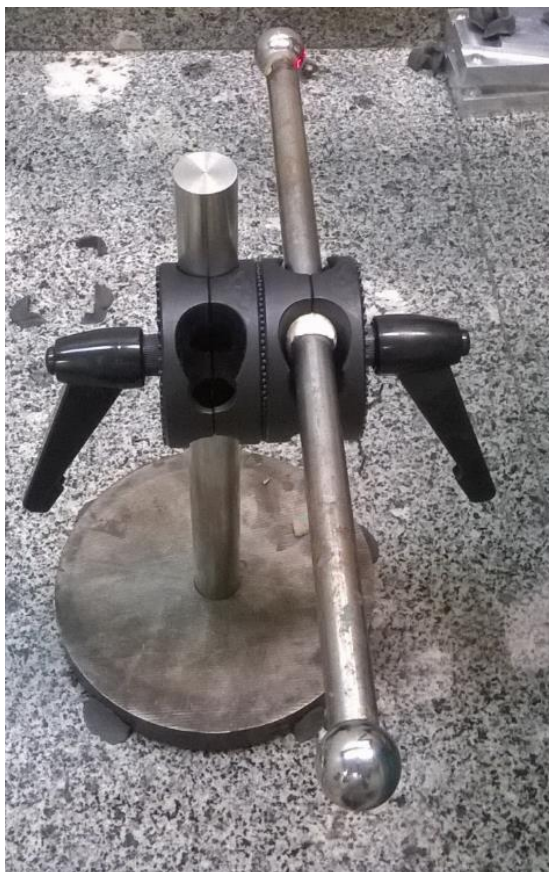
Figura 5. Avaliação da exatidão de medição dimensional com barra de esferas
