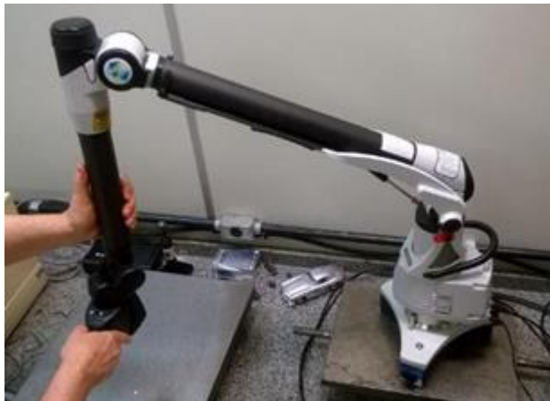
Figura 1. Sistema de Medição por Coordenadas portátil com apalpação por triangulação laser
