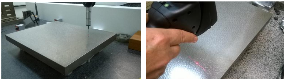
Figura 6. Avaliação da exatidão de medição de forma na MMC e no Braço de Medição com apalpação laser
