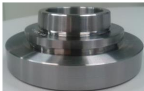
Figura 3. Engrenagem semi-usinada – Material 19MnCr5G
