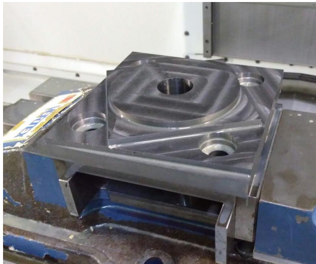
Figura 5 – Pré-forma da peça a ser utilizada no ensaio da máquina ferramenta
