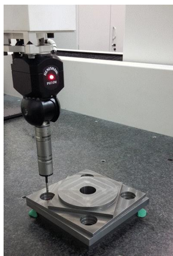
Figura 6 – Medição da peça usinada em máquina de medir por coordenadas
