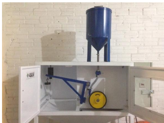
Figura 9. Abrasômetro com roda de borracha localizado no Laboratório de Transformação Mecânica da UFRGS (LdTM).
