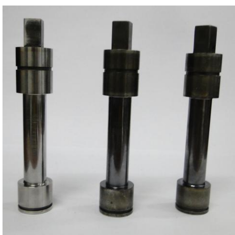
Figura 2. Pino polido, pino nitretado e pino com TiCN.
