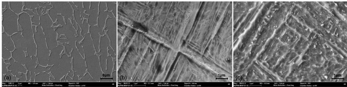
Figura 6. Microscopia eletrônica de varredura: (a) Ti6Al4V comercial - ampliação 5000X, (b) Ti6Al4V FSL - ampliação 30000X e (c) Ti6Al4V FSL+TT - ampliação 30000X.
