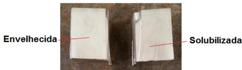
Figura 10. Imagem das peças cortadas com jato d'água abrasivo. Inconel 718 (Envelhecido e Solubilizado)
