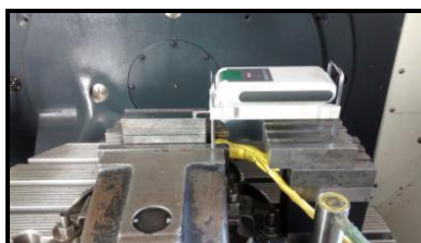
Figura 6. Medição da rugosidade durante o ensaio.
