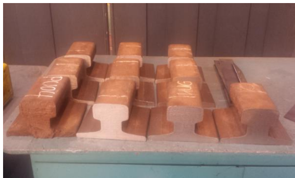
Figura 7. Trilhos preparados para soldagem através do processo SMAW
