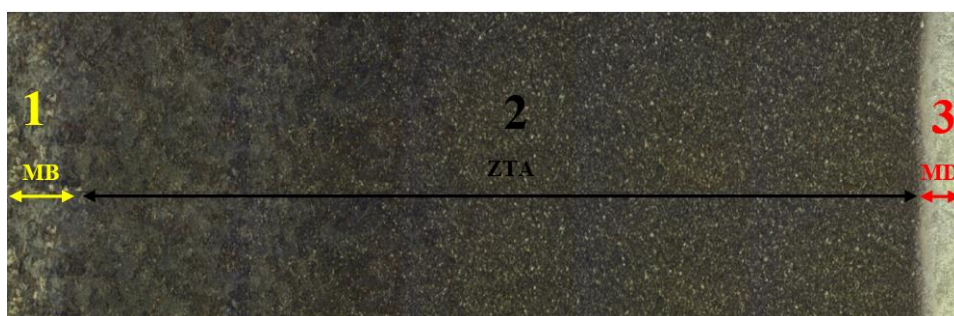
Figura 13. Microestrutura na ZTA no processo de soldagem SMAW soldado com Aço DIN 536 S900 com aumento de 25 vezes.
