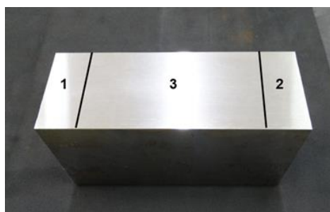
Figura 8. Corpo de prova preparado para análise química e micrografia
