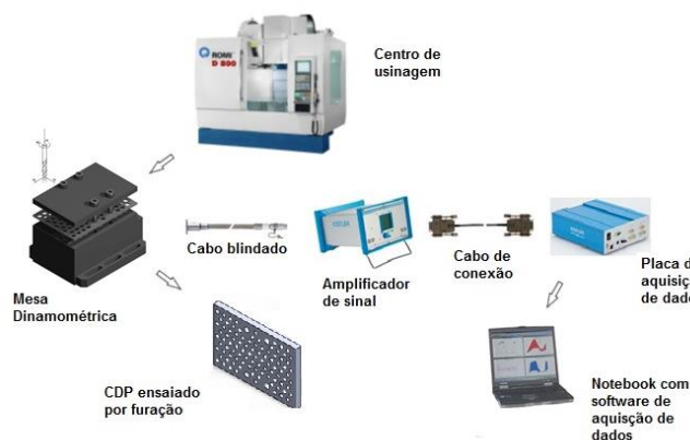
Figura 4. Configuração utilizada para a Mesa do Dinamométrica na aquisição de força de usinagem (Furação). Adaptado do grupo Kistler (2013).
