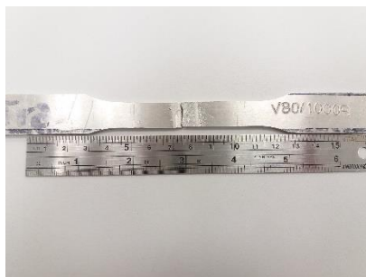
Figura 10 – Ruptura sobre o cordão de solda para velocidade de soldagem de 100 mm/min. Fonte: os autores, 2016.
