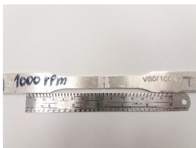
Figura 8 – Ruptura sobre o cordão de solda para velocidade de soldagem de 60 mm/min. Fonte: os autores, 2016.
