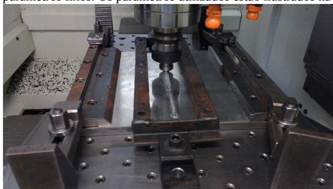
Figura 3 – Experimento de soldagem FSW. Fonte: os autores, 2016.
