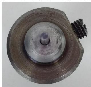
Figura 2 (B) – Ferramenta de soldagem FSW. Fonte: os autores, 2016.
