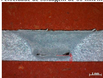
Figura 4 – Macrografia da seção transversal (reagente poulton's) aumento 12,5 X. Fonte: os autores, 2016.
