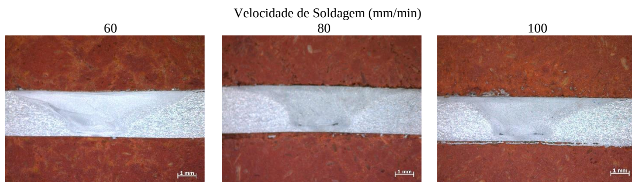
Figura 11 – Macrografia da seção transversal (reagente poulton's) aumento 12,5 X. Fonte: os autores, 2016.
