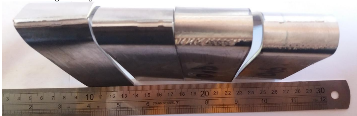
Figura 7 – Dobramentos de face e raiz para velocidade de soldagem de 100 mm/min. Fonte: os autores, 2016.
