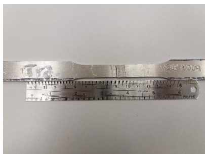
Figura 9 – Ruptura sobre o cordão de solda para velocidade de soldagem de 80 mm/min. Fonte: os autores, 2016.
