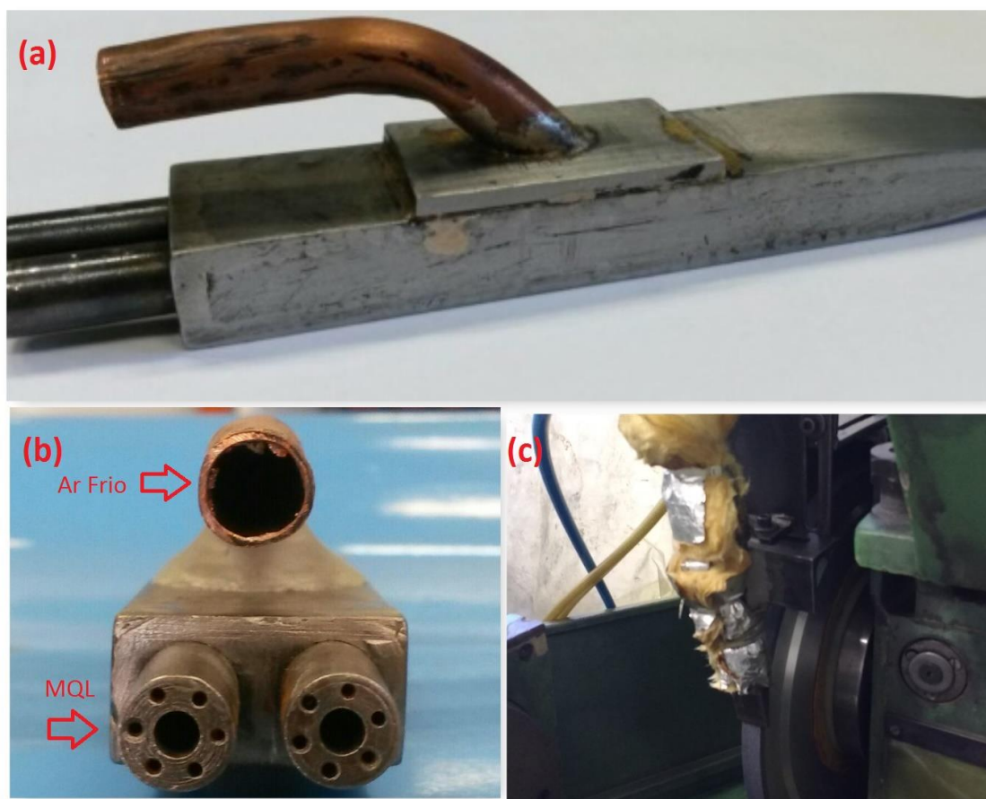
Figura 02: (a) Vista lateral do bocal aplicador; (b) Entradas de ar frio e MQL no bocal aplicador de CAMQL; (c) Montagem do bocal aplicador de CAMQL no rebolo. Fonte: Autor.
