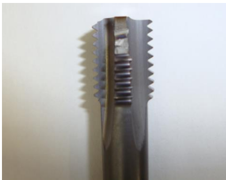
Figura 4 – Corte para a verificação da espessura de TiCN.
