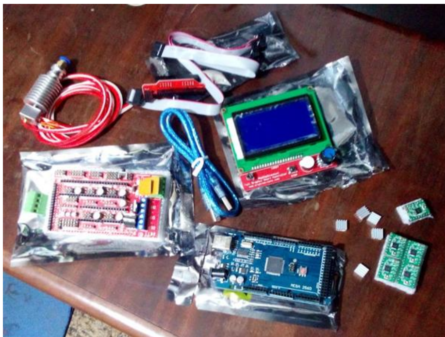
Figura 6. Kit eletrônico importado. Da esq. para direita: hot end , display LCD , 5 drivers para motor de passo, microcontrolador Arduino ATmega 2560 e placa de expansão shield RAMPS v. 1.4 (fonte: autoria própria).
