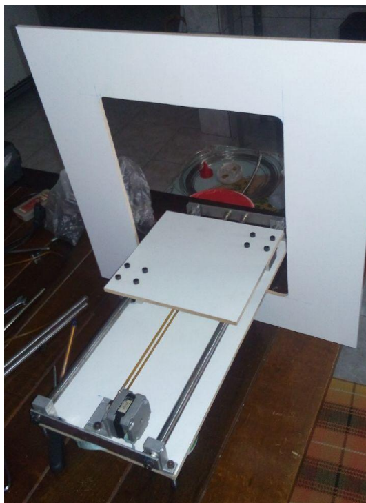
Figura 3. Estrutura da máquina com madeira MDF e partes em alumínio (fonte: autoria própria).
