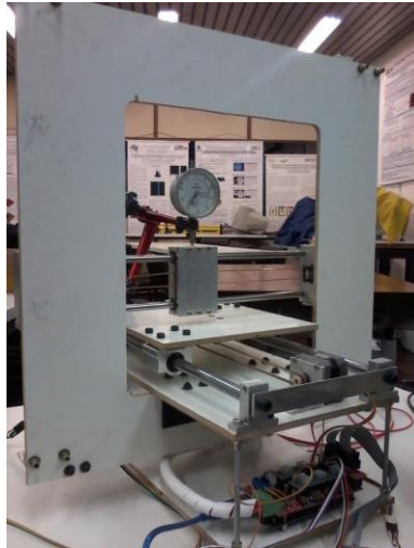
Figura 12. Calibração dos eixos com relógio comparador (fonte: autoria própria).
