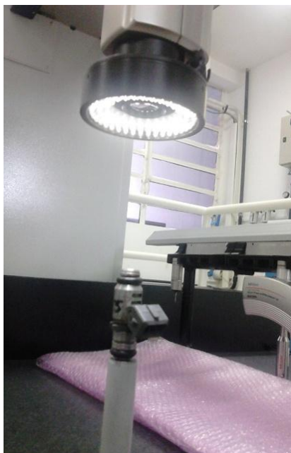
Figura 5. Medição do bico injetor de combustível
