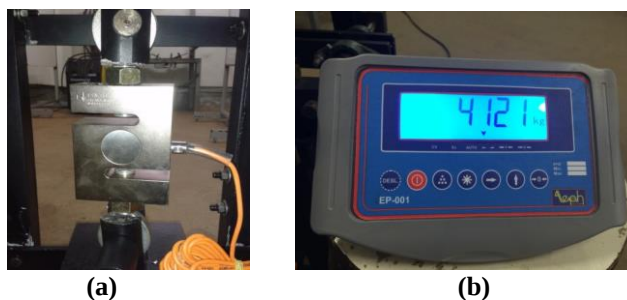
Figura 4. (a) Célula de carga modelo TSA. (b) Transmissor de pesagem que recebeu o sinal da célula de carga.
