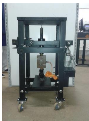
Figura 2. Equipamento para ensaio implante LTPSolda do DMM/IFMA-Campus Monte Castelo.
