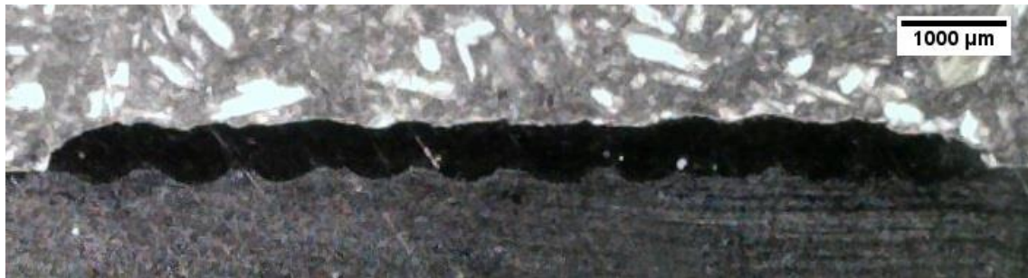
Figura 10. Seção transversal do melhor revestimento executado
