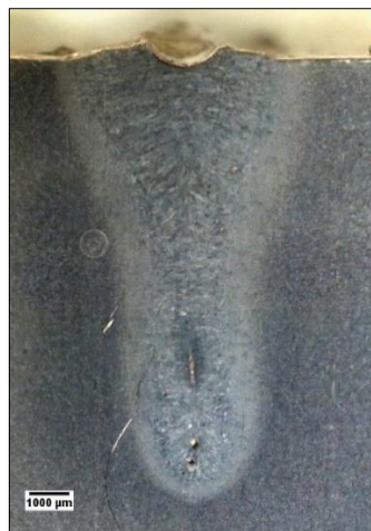
Figura 3 – Resultado do parâmetro inicial 1.6, porosidade e trinca de solidificação presente.
