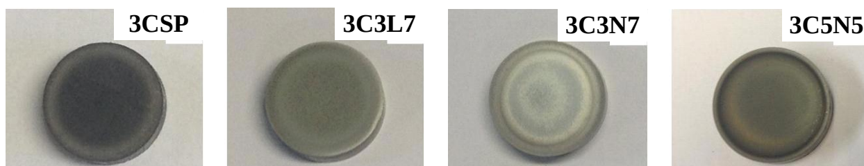
Figura 2. Imagem de topo das amostras cementadas durante 3 horas, a) 3CSP, b) 3C3L7, c) 3C3N7 e d) 3C5N5.
