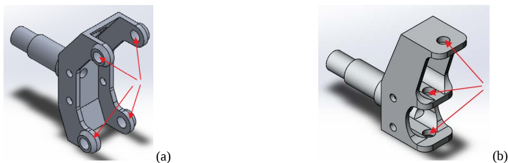
Figura 12. Desenho em perspectiva isométrica com indicação dos pontos de apoio da manga de eixo. (a) atual e (b) anterior
