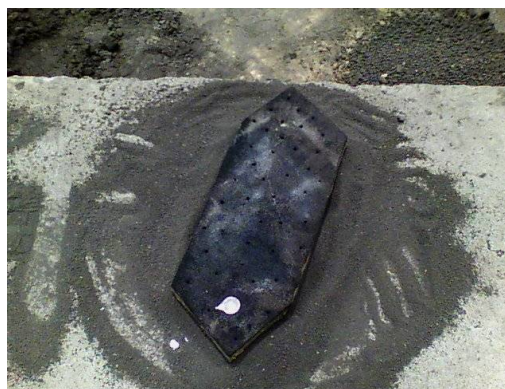
Figura 12. Molde modificado após a análise da imagem termográfica.
