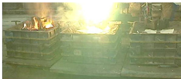
Figura 2. Moldes sendo preenchidos com o metal.
