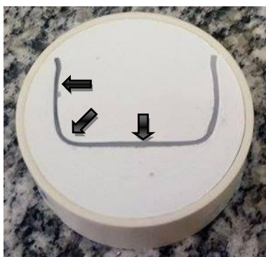
Figura 3. Corpo de prova mostrando posições de medida de microdureza (Autoria Própria).
