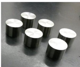
Figura 05: Amostras do aço GGD 4340 após a operação de corte.
