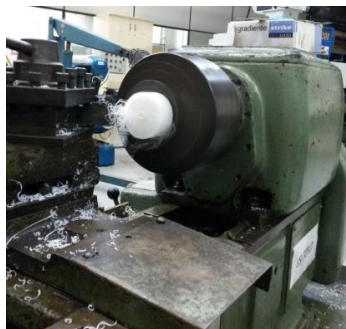
Figura 06. Construção do dispositivo de adaptação da bancada de condutividade térmica linear.
