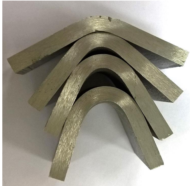
Figura 2. Amostras dobradas, de cima para baixo, dobradas a 120°, 90°, 60° e 30°, com a face analisada.
